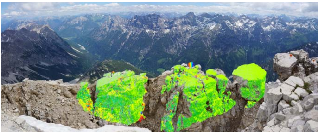
Abb. 2: Aus den Scandaten der Leica Nova MS60 können detaillierte Bewegungsprozesse des Hauptspalts abgeleitet werden.
